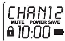
TBP12の送信をどのチャンネルに設定してあるかによって、**CHAN 1~CHAN 14**が上部に表示されます。トランスミッターがミュートされている場合のみ、**MUTE**アイコンが表示されます。**POWER SAVE**は、RFパワーモードが**LO**に設定されている場合にのみ点灯します。**ロックアイコン**は、トランスミッターがロックされている場合にのみ点灯します。ロックされている場合、電源をオフに切ることはできず、またエディットすることもできません。LCD の下部に表示される数字は、現在のパワーレベルによる電池の動作時間の残量を時間と分で表示しています。残り時間は20分単位で更新されます。**注意:** 操作開始直後の数分間は、正しい電池のデータが表示されないことがあります。電池の寿命が1時間以上ある場合は、**電池**アイコンが点灯します。電池の寿命が1時間を切ると、アイコンは点滅し始めます。
