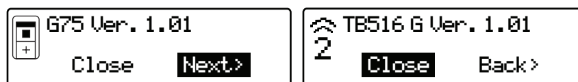
エディットモード - 接続されたトランスミッターのファームウェアバージョン画面
