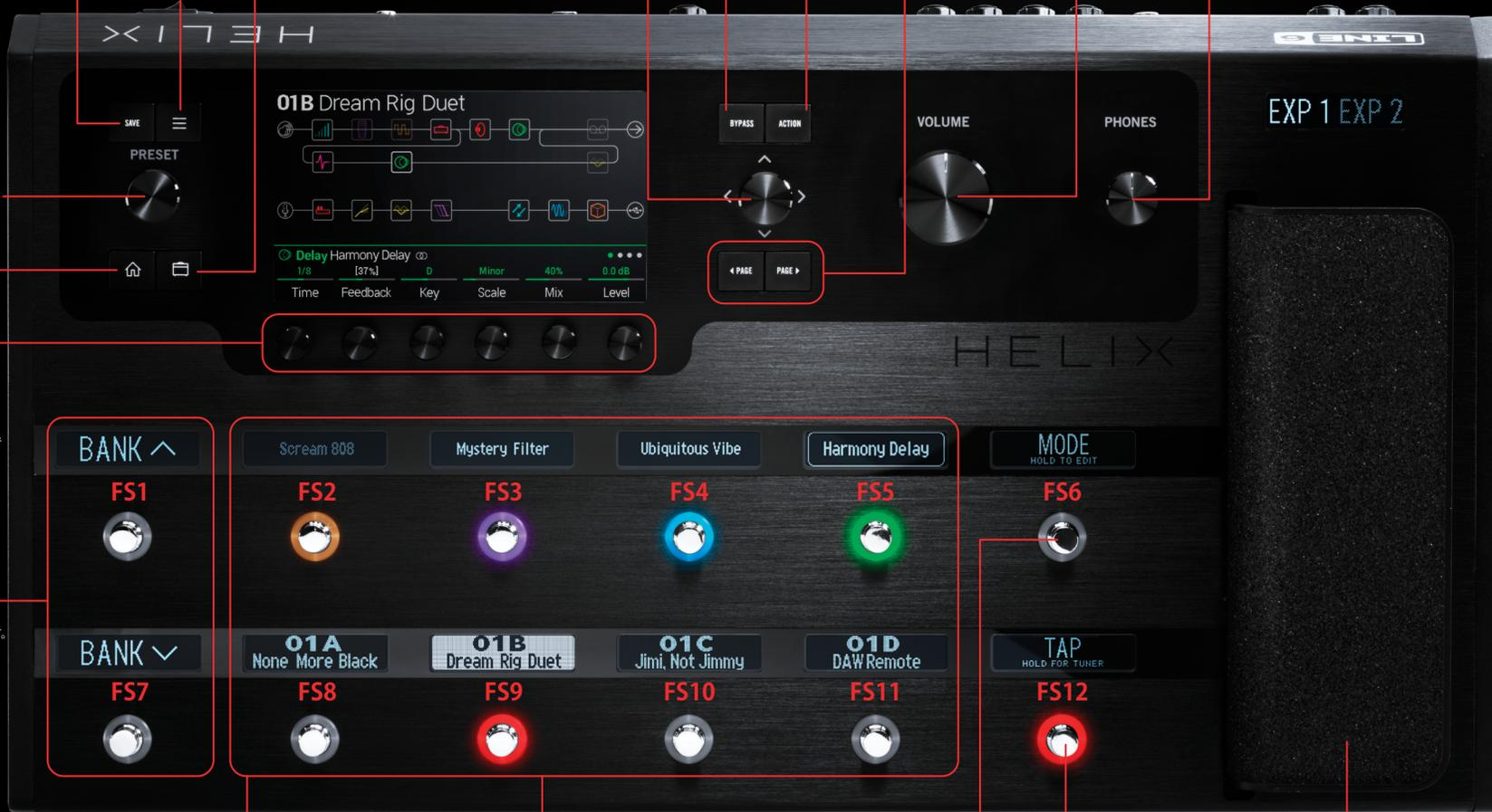
インプット・ブロックを選択し、ジョイスティックを回してインプットのソースを選択してください。各バスには1つまたは2つのインプット・ブロックを使用できます。
